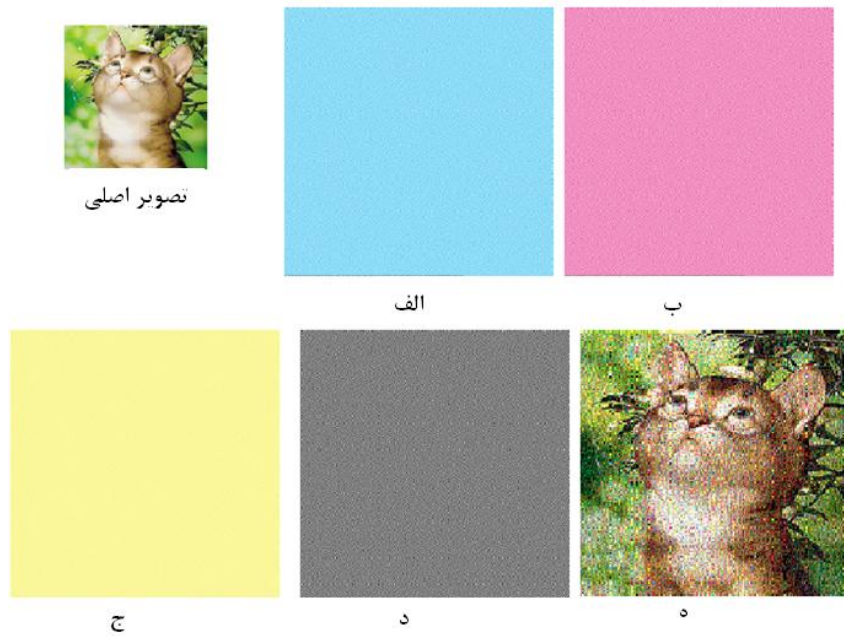
شکل ۱۲: چهار بخش و نتیجه انباشتن آنها الف) بخش ۱ (ب) بخش ۲ (ج) بخش ۳ (د) ماسک (ه) نتیجه انباشتن بخش‌ها
