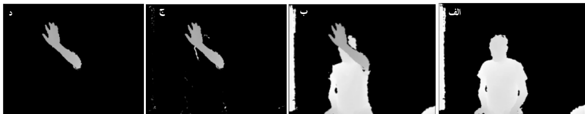
شکل ۶- استفاده از فیلتر Blob برای حذف حباب‌های ریز در تصویر (الف) تصویر مرجع (ب) تصویر جاری، (ج) تفریق تصویر جاری از تصویر مرجع، (د) نتیجه اعمال فیلتر Blob.
