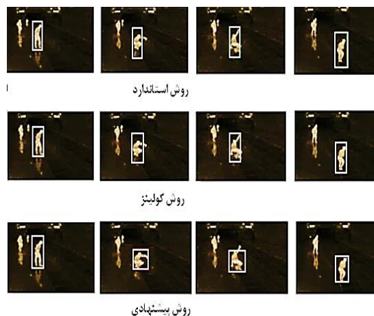
شکل ۶. دنباله‌ی هدف در تصویر مادون قرمز. نتایج اندازه‌بندی سه روش استاندارد، روش کولینز و روش پیشنهادی در قاب‌های ۱، ۳۵، ۴۰ و ۶۵.
