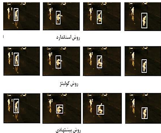
شکل ۹. دنباله‌ی هدف در تصویر مادون قرمز. نتایج اندازه‌بندی سه روش استاندارد، روش کولینز و روش پیشنهادی در قاب‌های ۱، ۳۵، ۴۰ و ۶۵.
